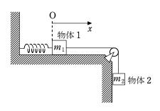
きにx 軸をとり、ばねが自然の長さのときの物体1の左端をx 軸の原点とする。また、重力加速度の大きさを $g[m/s^2]$ とする。ただし、滑車とばね、および糸の質量は無視できるとする。
