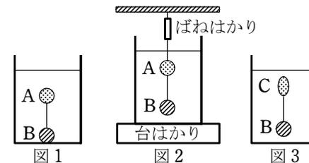
の上にビーカーを置き、物体Aをばねはかりにつけて持ち上げると、物体Aは完全に水没した状態で物体Bもビーカーの底から離れた。このとき、ばねはかりの目盛りの読みが  $4.0 \text{ g}$ 、台はかりの目盛りの読みが  $482 \text{ g}$  であった。次に、物体Aと同じ密度で体積が1.5倍の物体Cと物体Bを糸で結んで、同様に水に沈めたところ、図3のように、物体BとCは完全に水に没して水中に浮かんだ。水の密度を  $1.0 \text{ g/cm}^3$ 、重力加速度の大きさを  $9.8 \text{ m/s}^2$  として、次の問いに答えよ。
